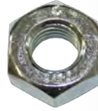
Sechskantmuttern DIN 934 (aktuell DIN-EN-ISO 8673) galv. verzinkt, Feingewinde Hexagon nuts, fine pitch thread, cl. 8, (Current DIN-EN-ISO 8673), zinc plated Cr3+
