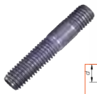
Stiftschrauben (Stehbolzen), DIN 939 Einschraubende 1,25 d, Güte 5.8, blank Studs, cl. 5.8 - Metal end » 1.25 d
