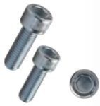
Zylinderschrauben mit Innensechskant DIN 912 (aktuell DIN-EN-ISO 4762) Güte 8.8, galv. verzinkt Hexagon socket head cap screws, class 8.8 (Current DIN-EN-ISO 4762), zinc plated Cr3+
